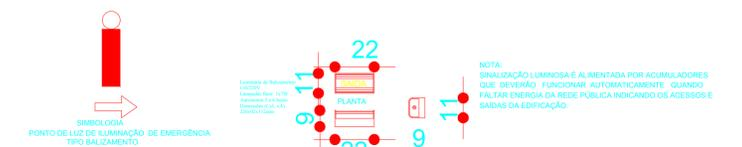
DET. ILUMINAÇÃO DE EMERGÊNCIA TIPO BALIZAMENTO
