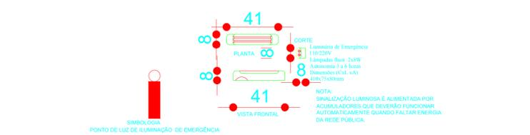
DETALHE ILUMINAÇÃO DE EMERGÊNCIA
